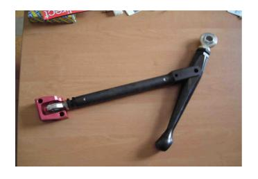
Braccio sosp. Completo di unibol motorsport e supporto inferiore in Ergal con boccole 875.00 euro cad.
